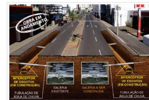
Para captar os esgotos lançados dentro das galerias de água de chuva, sob as avenidas centrais de Uberaba, o Codau está implantando os interceptores de esgotos na área central da cidade. São 26 km de tubulações que irão transportar os esgotos até a ETE Rio Uberaba. Desta total, 73% foram concluídos em 2011.
