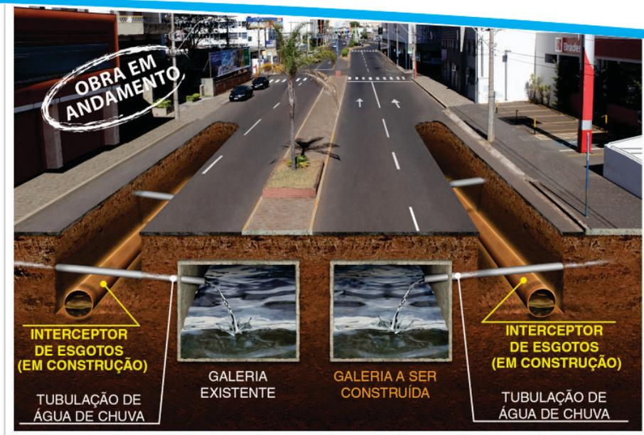
Para captar os esgotos lançados dentro das galerias de água de chuva, sob as avenidas centrais de Uberaba, o Água Viva está implantando os interceptores de esgotos na área central da cidade. São 26 km de tubulações que irão transportar os esgotos até a ETE Rio Uberaba.
